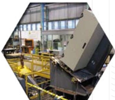
Испытания шкафа в соответствии с MIL-STD-901D
