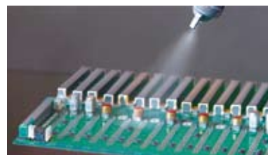
Нанесение конформного покрытия
