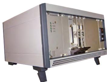
Если проект заказчика предполагает использование вычислительных модулей, работающих в промышленном диапазоне температур, поддерживающих «горячую» замену ключевых элементов и выдерживающих значительные ударные и вибрационные нагрузки, то в данном случае идеальным решением будут магистрально-модульные системы стандарта CompactPCI.
